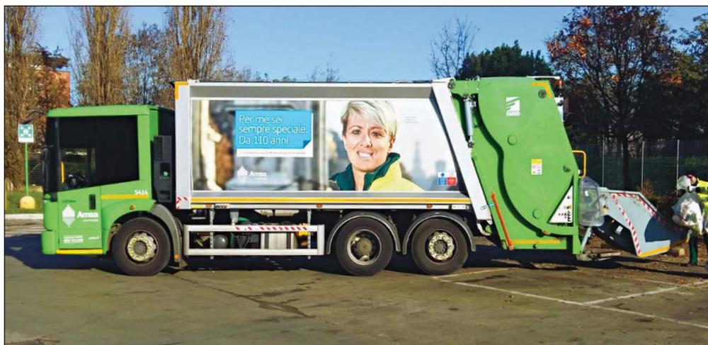
Autocompattatore a tre assi.
