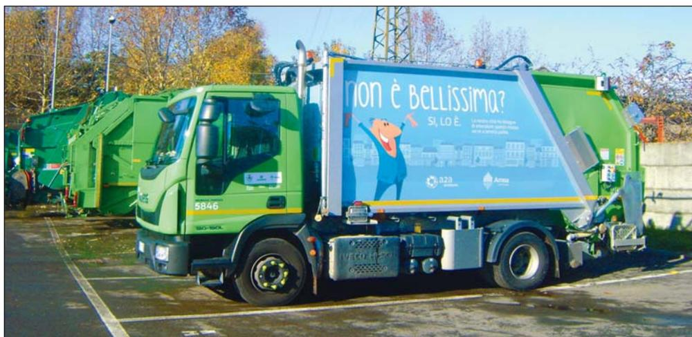
Autocompattatore a due assi.
